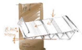
Une inclinaison interne de 8,75 % sur la partie supérieure des lames assure un drainage parfait et empêche l'accumulation d'eau dans le système.
