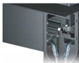
Grâce au système de circulation et de collecte d'eau, le toit peut être complètement plat, sans inclinaison minimale, et empêcher l'eau de s'infiltrer.
