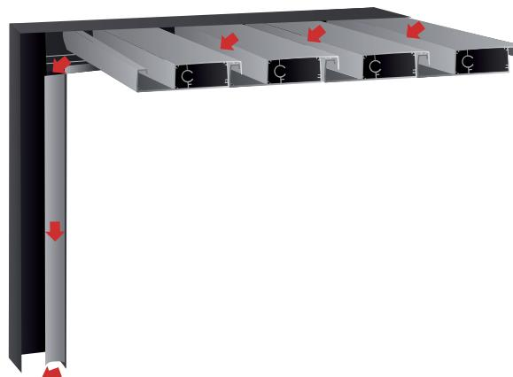
L'eau s'écoule à travers les lames et dans la gouttière, qui dirige l'eau de pluie vers l'extérieur via la descente, par drainage libre ou canalisation au sol.
